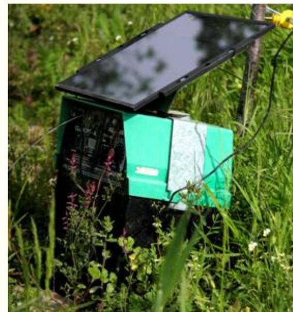
Alimentatore della recinzione elettrificata ricaricato da un pannello solare (per ridurre i tempi e costi della manutenzione)
